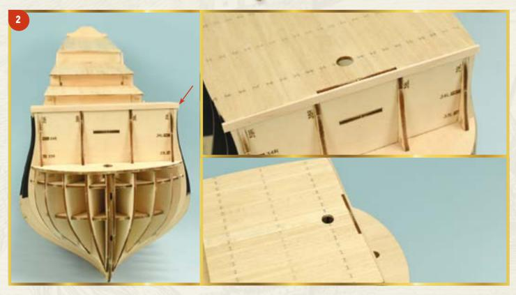
2 Перейдем к обшивке носовой переборки модели. Отрежьте от планки сечением 1,5 х 5 мм фрагмент необходимой длины и приклейте его так, чтобы его верхний край был заподлицо с настилом палубы (см. фотографию). Планка должна слегка выступать с обеих сторон за края первого шпангоута.
