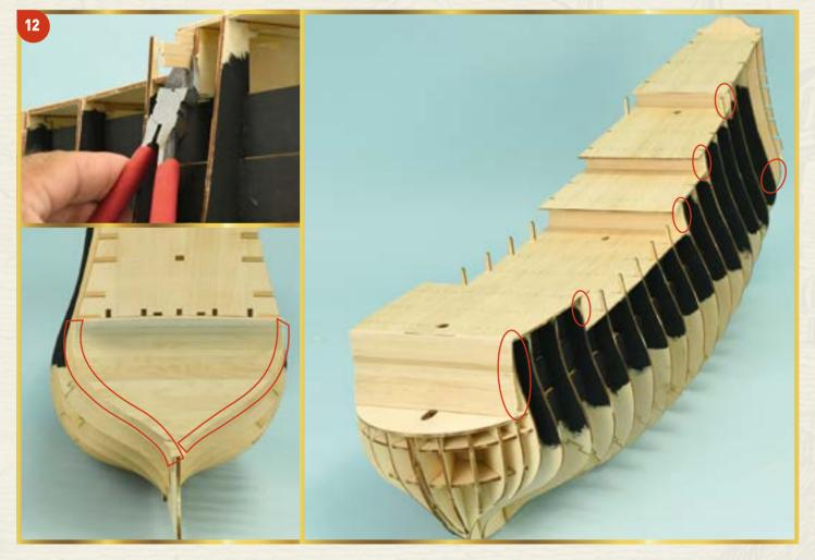
**12** С помощью кусачек или ножа обрежьте все выступающие части приклеенных вами на данном этапе планок, чтобы они не выступали за границы соответствующих шпангоутов модели.
