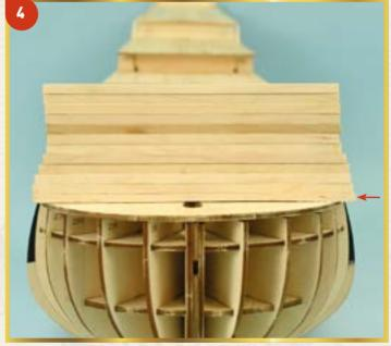
4 Руководствуясь фотографией, полностью обшейте носовую переборку. Когда клей окончательно высохнет, обработайте наклеенные планки наждачной бумагой, чтобы их поверхность стала абсолютно гладкой.
